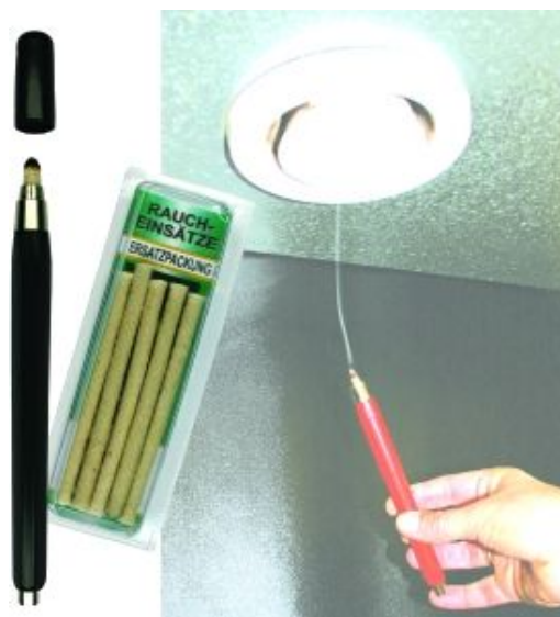
Świece dymne (użyteczne przy inwentaryzacjach połączeń)
